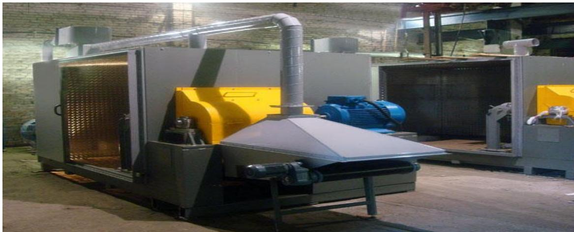
Рисунок 1. Мобильный комплекс по переработке автошин КПШ-1[26]
