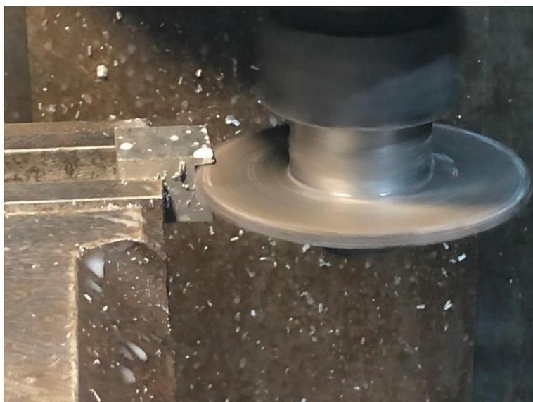
Рисунок 3 - Фрезеровка пазов для верхнего диска
