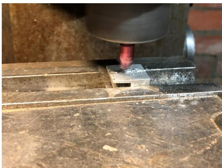
Рисунок 6 - Фрезеровка направляющего паза для нитки
