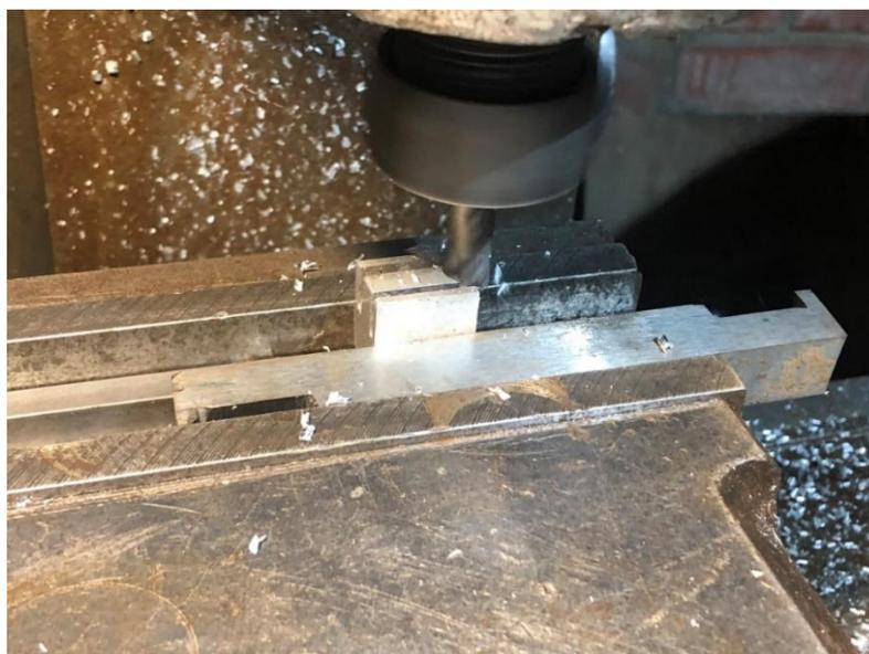
Рисунок 5 - Фрезеровка плоскости между пазами
