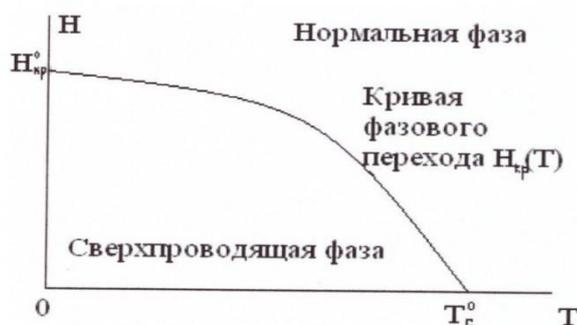
Рис.2. Кривая фазового перехода из сверхпроводящего состояния в нормальное в зависимости от величины напряженности внешнего магнитного поля.
